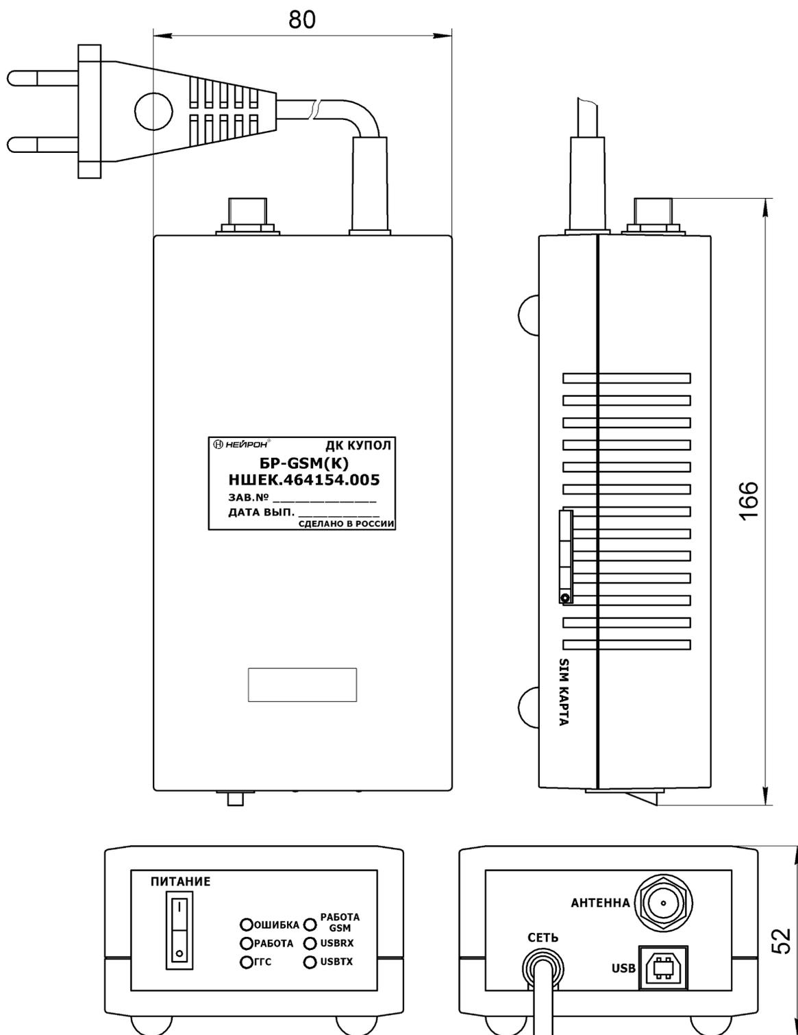
Рис.1 Внешний вид блока радиоканала БР-GSM(К) НШЕК.464154.005
